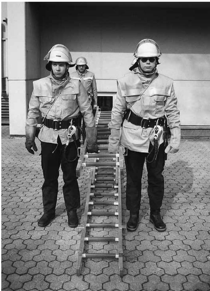
Die zusammengesteckte Leiter wird danach an die Wand des Objekts geschoben; die Federsperrbolzen an den zusammengesteckten Leiterteilen müssen nun eingerastet sein.
