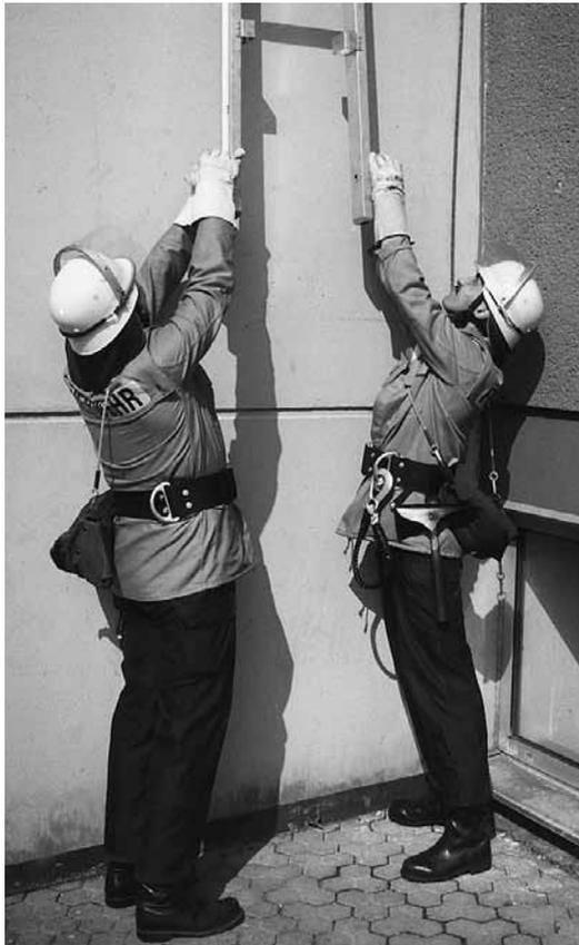
Ein weiteres Leiterteil wird vom dritten Feuerwehrangehörigen beziehungsweise vom anderen Trupp in die Kästen der hochgeschobenen Leiter eingeschoben und die Federsperrbolzen werden durch Drehen zum Einrasten gebracht.
