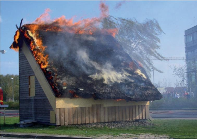
Abbildung 15 - Entweichen Wasserdampf aus den tieferen Reetschichten
