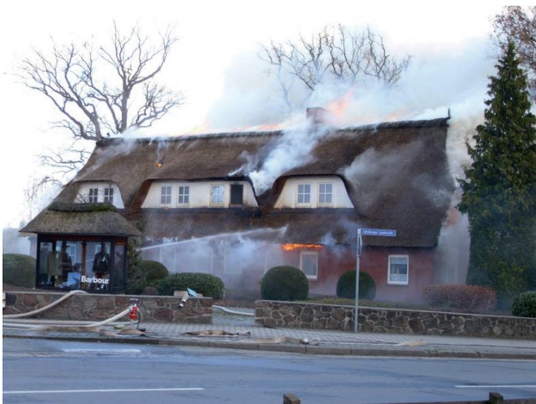
Abbildung 25 - Feuer dringt bereits aus Öffnungen in der Eindeckung und unterhalb der Traufe aus
