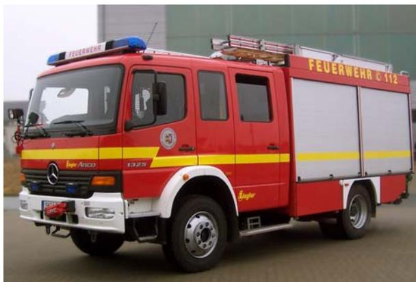
Bild 3: Hilfeleistungs-Löschgruppenfahrzeug
