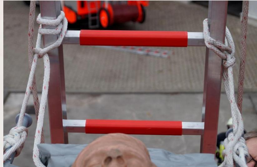
Sicheres ablassen wird durch die seitlichen Führungsleinen gewährleistet
